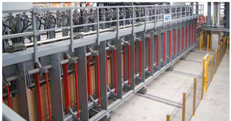
Unter Hochdruck: Die Buchen-LVL-Lamellen werden in der H.I.T.-Lignopress zu einem 18 m langen Binder verpresst, dabei baut die Presse bis zu 3 N/mm 2 Druck auf. Das ist dreimal so viel wie bei Fichte
