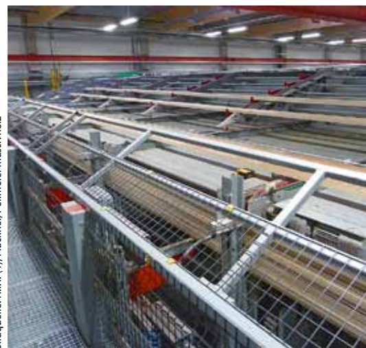
Binderbildung: Von oben kommen die Decklamellen, von unten die beleimten Mittellamellen
