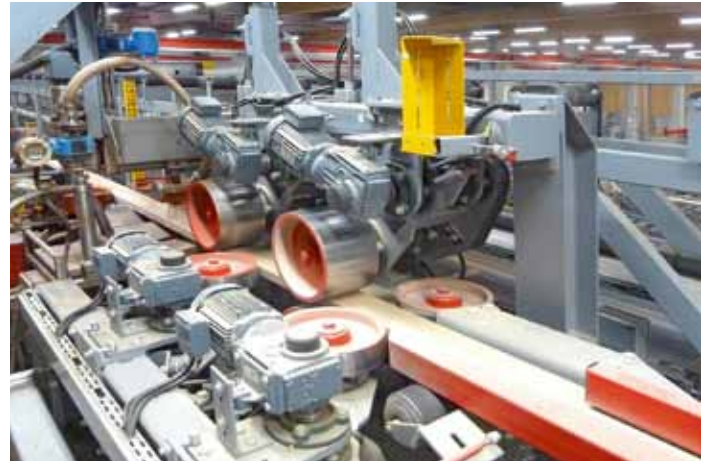
Mit bis zu 350 m/min sausen die 4 cm starken Baubuchenlamellen durch den Leimvorhang, wo sie mit Resorcinharz beaufschlagt werden
